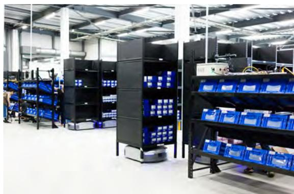
庫内作業における省人化促進のため、ギークプラス社の「EVE」や、中国Quicktron社のAGVなど、無人搬送ロボットの導入を支援しています。
